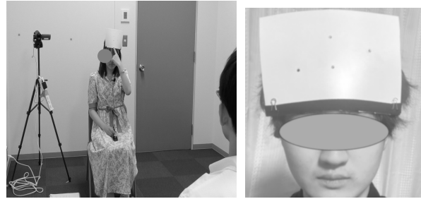
図1 指さし配置条件における課題開始時の作業者（左図）と作業者のプラスチック板と4色のステッカー（右図）
